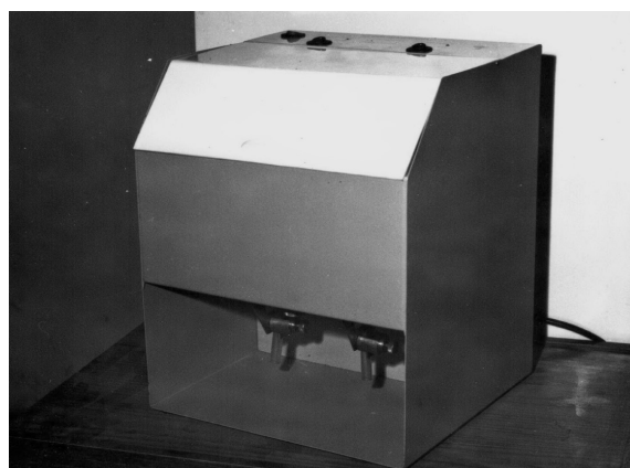
Рис. 2. Аппарат для выделения личинок трихинелл
